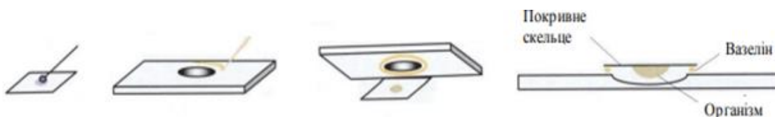
Рис. 9. Схема виготовлення препарату «висяча крапля»
