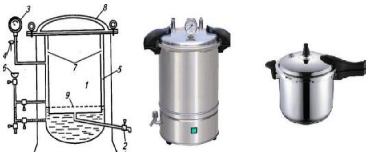
Рис. 5. Схема автоклава: 1 – стерилізаційна камера; 2 – кран для виходу повітря; 3 – манометр; 4 – запобіжний клапан; 5 – водопарова камера; 6 – воронка для заповнення автоклава водою; 7 – отвори для надходження пари в стерилізаційну камеру; 8 – кришка автоклава; 9 – підставка для розміщення матеріалів, що стерилізуються
