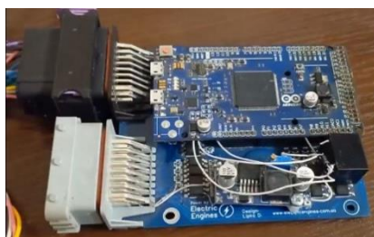
Рис.3 Варіант III збірки схеми принципової схеми для пробудження систем електромобіля
