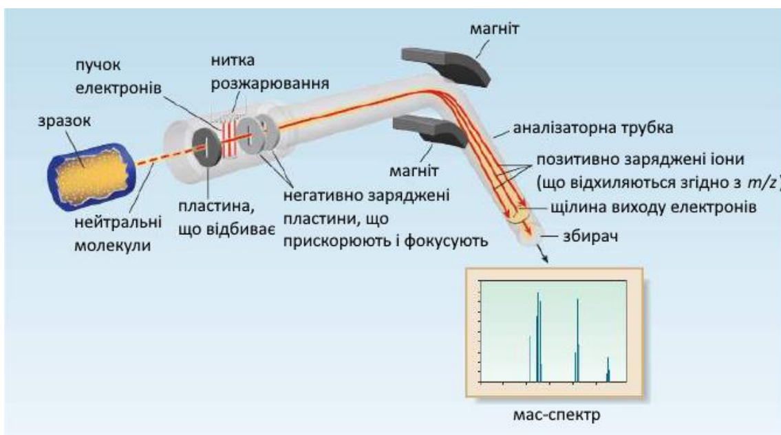
Рис. 1.1. Схема мас-спектрометра
