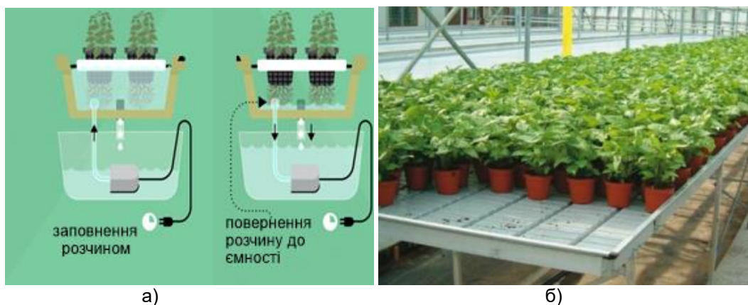
Рис. 4. Схема та приклад застосування гідропонної установки за системою Ebb and Flow
