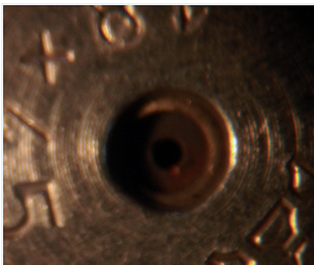
Рисунок 4. Сквозное прогорание электроискрового разрядника травматического патрона 18×45Т под действием электрического импульса схемы воспламенения пистолета «Оса ПБ-4-1»
