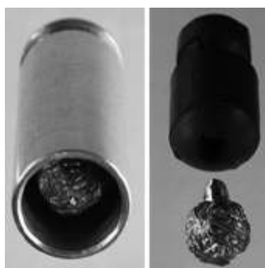
Рисунок 3. Патрон травматического действия 18х45 мм с самодельно внесенными изменениями пули (крепление дополнительного, изготовленного из свинца, снаряда)
