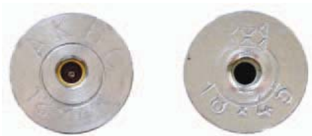
Фото 8. Следы контактного узла на дне стреляных гильз патронов разных производителей
