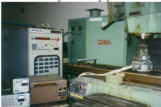
Рис. 5. Експериментальний стенд на базі вертикально-фрезерного верстата з вимірювальним модулем [7]
