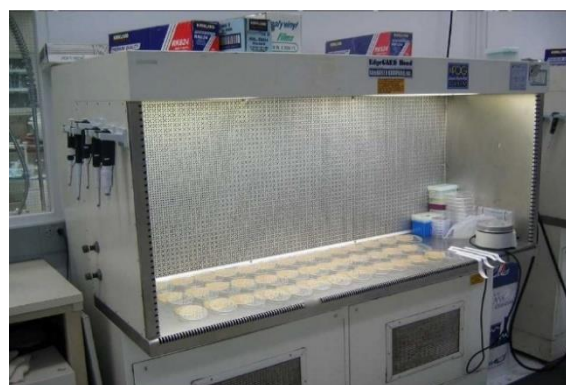
Рис. 4 – Ламінарний бокс із горизонтальним потоком повітря
