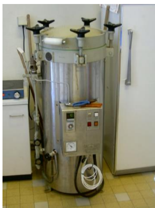
Рис. 22 – Автоклав: 1 – камера стерилізації; 2 – кран для виходу повітря; 3 – манометр; 4 – запобіжний клапан; 5 – камера; 6 – лійка для заповнення автоклава водою; 7 – отвори для надходження пари в камеру стерилізації; 8 – кришка автоклава; 9 – підставка для розміщення матеріалів, що стерилізуються
