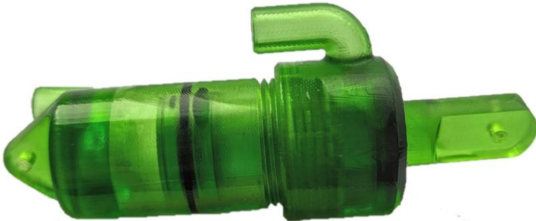
Рис.1а. 3D-друкований гідравлічний циліндр прибл. 6 см в довжину
