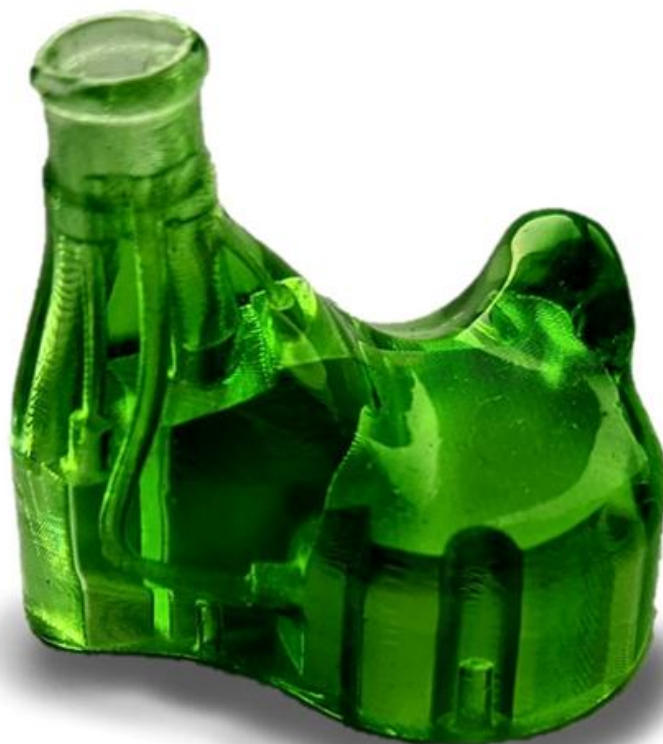
Рис .2. Надруковані на 3D-принтері навушники зі складною конструкцією акустичної капілярної трубки
