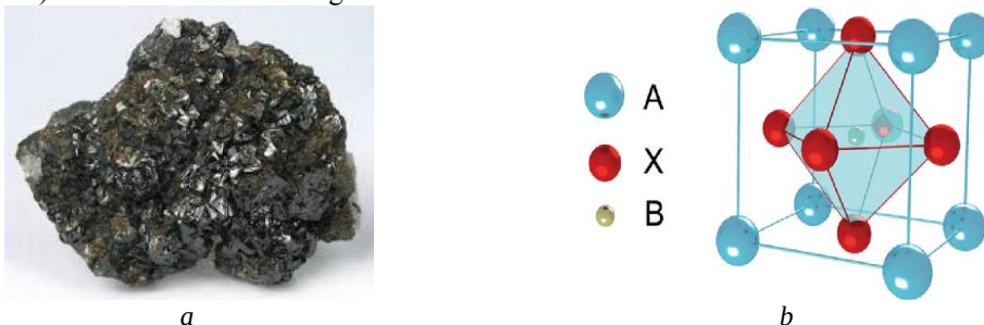
Fig. 3. Imaginea rocii de perovskit (a) [9, p. 1]; Celulă Bravais cubică ideală (b) [10, p. 10491]
