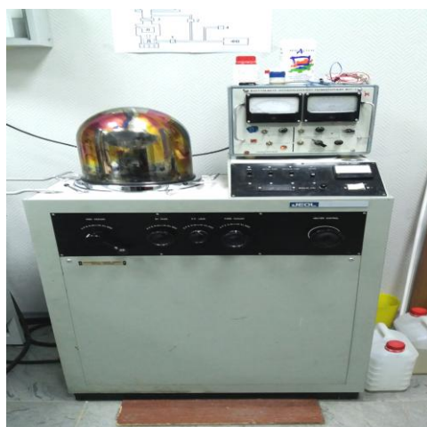
Fig. 3. Instalație de evaporare termică în vid
