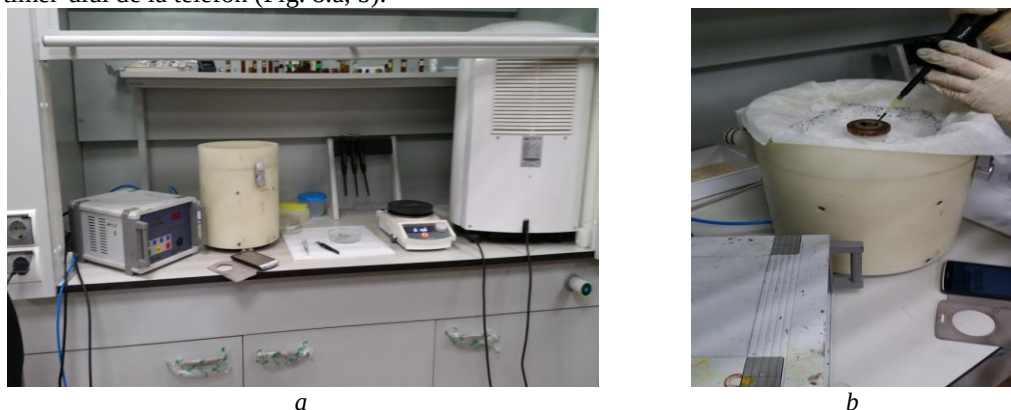
Fig. 8. (a) Instalația de depunere prin metoda “spin coating” și cuptorul cu timer; (b) Procesul de depunere a substanței cu catalizatorul la rotirea măsufei de lucru
